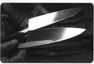
■刃付け(研ぎ) 荒研ぎ～本研ぎ～中研ぎ～ぼかし～仕上げ研ぎの工程で包丁の刃付けを行います。
